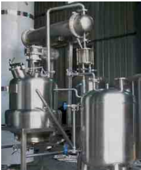
Auf dieser Extraktionsanlage (geeignet sowohl für Wasser- und Wasser/Alkohol Extraktion) werden unter anderem Beta Ecdysteron, D-Pinitol, MHCP, Polypeptid P, 4 Hydroxy-Iso-leucine hergestellt.
